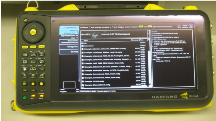
Система ультразвукового сканирования VEO-TOFD с функцией обнаружения поперечно расположенных трещин
